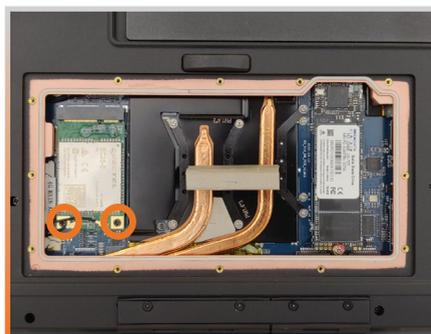
3. Deslizar Módem 4G hacia abajo y levántelo **sin retirarlo**.
