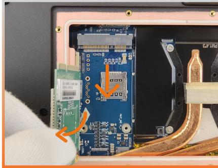
4. Abrir slot de tarjeta SIM deslizando la tapa hacia abajo y colocar la tarjeta micro SIM tal y como se muestra en la siguiente imagen.
