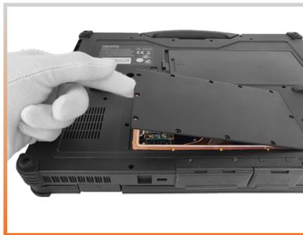
2. Desatornille x2 tornillos de la parte de abajo del Módem 4G.
